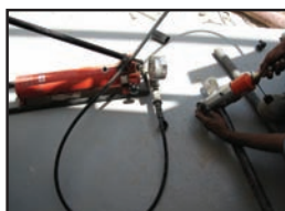
Bomba manual de Hi-Force accionada con el pie, completa con accesorios. Para conocer las especificaciones de la bomba, véase la página 23, modelo HP227FP.
